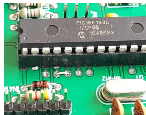
Abb. 4: Drahtbrücke für modifizierten Spannungsteiler
