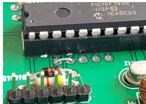
Abb. 3: Drahtbrücke für originalen Spannungsteiler
